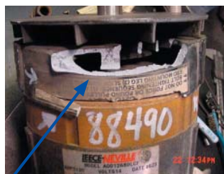
(D) Broken Housing
