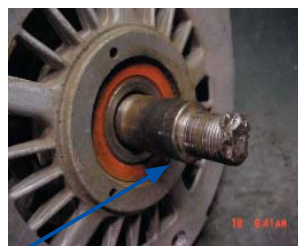
(D) Damaged Shaft
